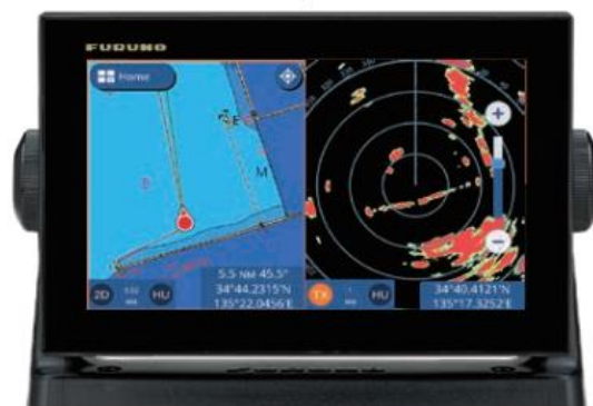
Conexión inalámbrica entre DRS4W y GP-1971F
