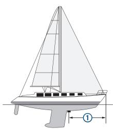
2 Desde una vista de sonda pertinente, selecciona MENU > Configuración de sonda > Instalación > Variación de proa
